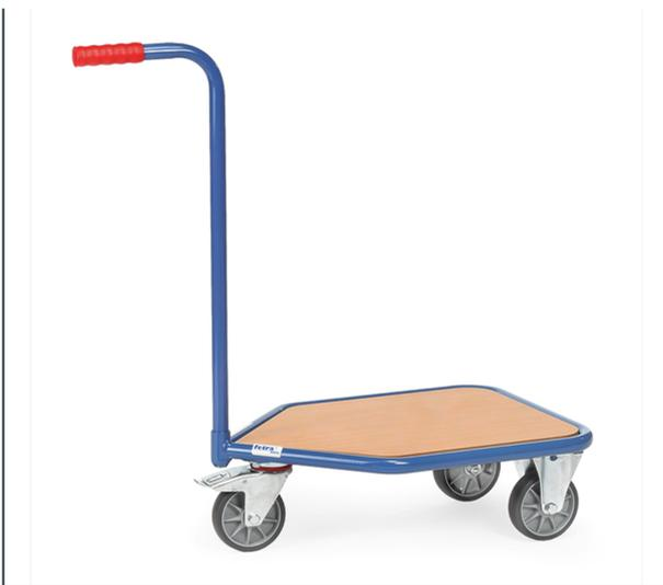
Griffroller aus Stahlrohr geschweißt, pulverbeschichtet brillantblau RAL 5007 mit Holzplattform. Plattform mit im Rahmen liegender Holzwerkstoffplatte, Oberfläche Buchendekor. Griff anschraubbar, 1 Lenk- und 2 Bockrollen, TPE-Bereifung, Naben mit Rillenkugellager, Feststeller an den Lenkrollen.
