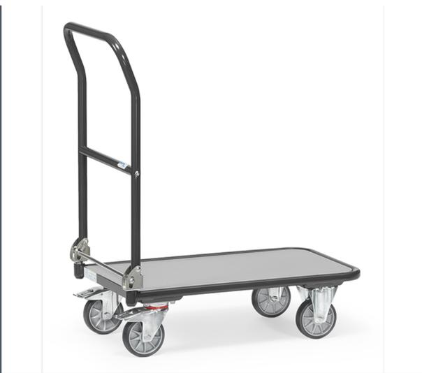
Klappwagen aus Stahlrohr, pulverbeschichtet anthrazitgrau RAL 7016. Ladefläche aus Holzwerkstoffplatte, Oberfläche mittelgrau. Schiebebügel auf Plattform klappbar. 2 Lenk- und 2 Bockrollen, TPE-Bereifung (spurlos), Naben mit Rillenkugellager. Feststeller an den Lenkrollen.
