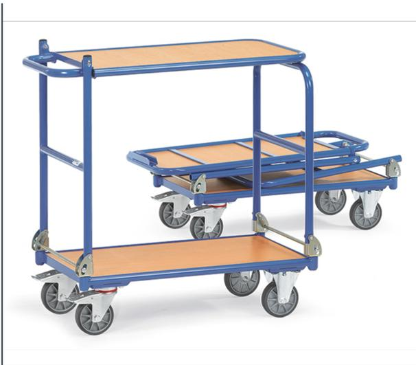
Stahlrohr-Tischwagen, pulverbeschichtet brillantblau RAL 5007, Ladefläche aus Holzwerkstoffplatte, Oberfläche Buchendekor. Mit 2 klappbaren Bügeln und mit klappbarer Tischplattform. 2 Lenk- und 2 Bockrollen, TPE-Bereifung, Naben mit Rillenkugellager. Feststeller an den Lenkrollen. Tragkraft obere Ladefläche 80 kg. Deutsches Patent 100 62 425.
