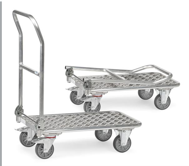
Alu-Rohrwagen mit Aluplattform, Schiebebügel auf Plattform klappbar. 2 Lenk- und 2 Bockrollen, TPE-Bereifung (spurlos), Naben mit Rillenkugellager. Feststeller an den Lenkrollen.
