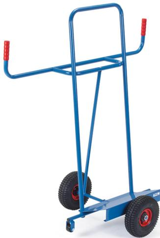
Stahlrohr-Konstruktion mit Stahlblechschaufel, pulverbeschichtet blau RAL 5007. Räder mit Luftbereifung. Naben mit Rollenlager. 2 Stützrollen 50 mm Ø. Zum Längstransport von großflächigen Holz- und Kunststoffplatten. Zerlegte Anlieferung.
