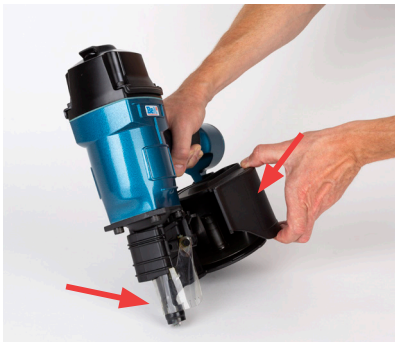
Überprüfung aller Schutz- und Magazinabdeckungen
