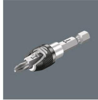
Wera Schnellwechselfutter stellen eine feste, wackelfreie Verbindung zwischen Halter und Bit her. Die Halter sind so konstruiert, dass beim Bitwechsel die äußere Hülse nach vorn geschoben wird und der Bit leicht eingesetzt und entnommen werden kann. In magnetischer Ausführung zum leichteren Ansetzen der Schrauben.
