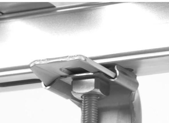
Die Schraube muss mit 25 Nm angezogen werden, um einen sicheren Halt zu gewährleisten.
