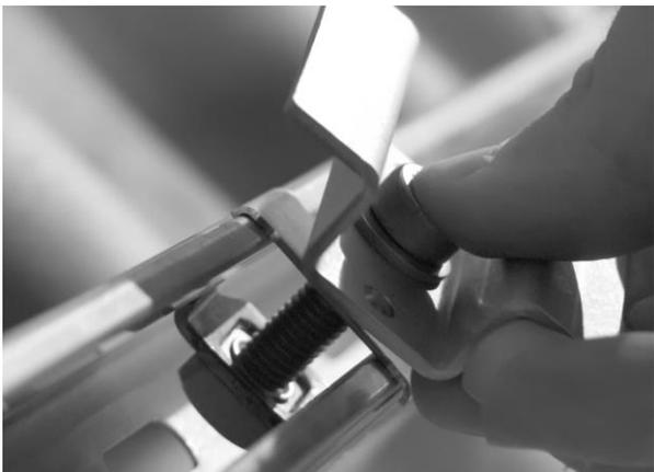
Drehung der Schraube um 90° im Uhrzeigersinn, führt zu Positionierung der Schienenmutter, sodass Klemme in der Schiene fixiert ist.
