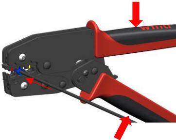
5.3 Korrekt abisoliertes Kabel bis zum Anschlag in den Kontakt einlegen. Werkzeug schließen, bis es automatisch wieder öffnet!
