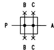
Zur Entnahme ungeölter Luft wenn der Verteiler vor dem Nebelöler angeflanscht wird.
