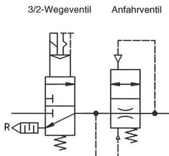
Belüftung der Anlage über Drosselstellung des Anfahrventils.
