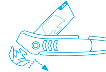
Halten Sie die Ersatzklinge **parallel** vor den unteren Griffbereich und setzen Sie sie ein. Danach Klingenkopf bis zum Anschlag **nach rechts** bewegen.
