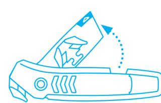
Ziehen Sie das **Klingenmagazin oben heraus**. Dadurch lösen Sie die Arretierung des montierten Klingenkopfes.
