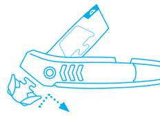
Halten Sie die Ersatzklinge **parallel** vor den unteren Griffbereich und setzen Sie sie ein. Danach Klingenkopf bis zum Anschlag **nach rechts** bewegen.
