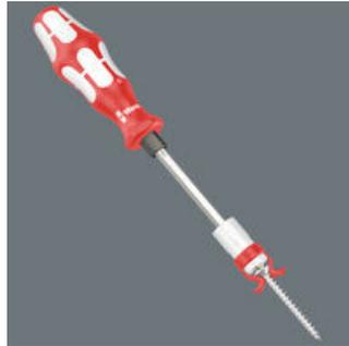
Die Schraubkralle hält alle Schraubenprofile und -größen sicher auf dem Werkzeug. Schraubkralle auf die Klingenspitze schieben bis das Klingensprofil aus der Gummi-Klingenaufnahme heraustritt. Schraube auf die Klingenspitze stecken, in der Schraubkralle fixieren. Schraubkralle weiter in Richtung Griff ziehen, bis sich die beiden Arme des Schraubengreifers an den Schraubenkopf anlegen und leicht aufspreizen.
