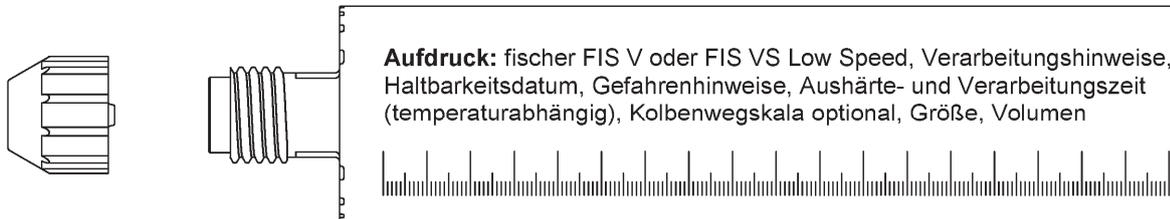
**Statikmischer FIS MR Plus für Injektionskartuschen bis 410 ml**
