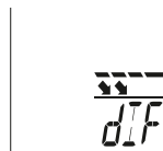
8. Difference infrarød temperatur (max/min)
