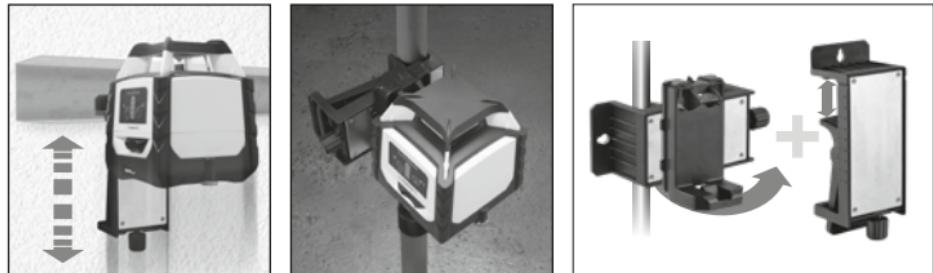
Seinäkiinnikkeen voi kiinnittää väliseinärakenteeseen puristuskiinnikkeen (5) avulla sekä pystyn että vaakaan.
