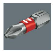
BiTorsion Bits sind absolute Premium-Bits. Mit weicherer BiTorsion-Zone, wodurch die Härte des Schaftes um ca. 20 % gegenüber der Abtriebsspitze reduziert wird. Dadurch wird das Verwinden der Bitspitze bei Belastungsspitzen auftretenden größtenteils vermieden, was die Lebensdauer des Bits noch weiter erhöht.
