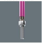
Die Klemmung der Innensechskant-Schraube auf dem Winkelschlüssel wird durch eine federnde Kugel gewährleistet. Besonders hilfreich in schwer zugänglichen Arbeitsbereichen, wo man die zweite Hand nicht zum Festhalten der Schraube nutzen kann.
