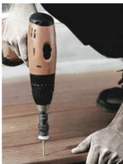
Bit-Halter zum gleichmäßig bündigen Versenken von Schrauben in Holzdielen beim Terrassenbau
