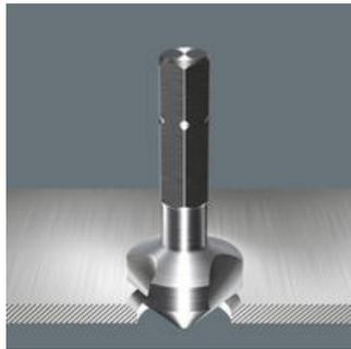
3-nutiger Kegelsenker-Bit, 90° • Einsatz: Zum Entgraten, Fasen, Senken • 1/4"-Antrieb passend für Halter nach DIN 3126-D 6,3 (ISO 1173) • Sehr gute Kraftübertragung durch Sechskantschaft • HSS = Hochleistungsschnell-Stahl • Fein abgestimmte Material- Elastizität für hohe Standzeiten • 3 Schneiden • Sehr gute Zentriereigenschaften • Problemloses Schneiden • Einwandfreie Spanabfuhr • Geringe Verkantungsgefahr • Präzise Rücklaufführung • Hoher Korrosionsschutz
