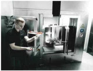
Die Stückprüfung bei 10.000 Volt gemäß IEC 60900 garantiert sicheres Arbeiten unter Spannung bis 1.000 Volt.
