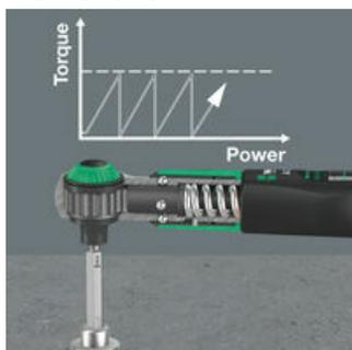
Der Drehmomentschlüssel Safe-Torque A 2 ist mit einer Überschmechmechanik ausgestattet. Nach Erreichen des eingestellten Drehmomentwertes kann das Werkzeug nicht überzogen werden, so dass das Aufbringen eines zu hohen Drehmomentes ausgeschlossen ist.
