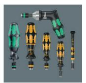
Wera Drehmomentschraubendreher. Mit werkseitig fest auf den kleinsten voreingestelltem Skalenwert Drehmomentwert. Für Anwendungen, bei denen konstant dasselbe Drehmoment benötigt wird und Wiederholgenauigkeit gefordert ist. Der Drehmomentwert kann mit einem Extra-Werkzeug innerhalb des Messbereichs verändert werden (Re-Kalibrierungs-Kit, bestellbar mit der Codenummer 05137003001). Danach mit einem handelsüblichen Drehmomentprüfgerät eingestellten Wert überprüfen.
