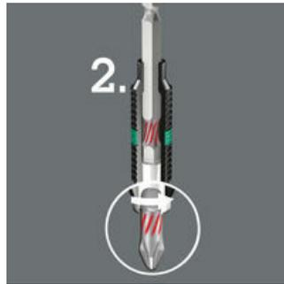
Größere Belastungsspitzen werden durch die Torsionswirkung des Bit-Schaftes minimiert (Phase 2). Diese Wirkung wird durch eine gezielte Sonderwärmebehandlung nach dem Härteprozess des Bits erzielt. Dadurch wird die Härte des Schaftes gegenüber der Abtriebsspitze reduziert.
