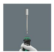
Durch erneutes, kräftigeres Betätigen der Hülse wird Lösemechanismus durch ein deutlich hörund fühlbares Überwinden des Arretierwiderstandes gelöst. Die Teleskopklinge kann entnommen Maschinenadapter und als eingesetzt, sowie in die Ausgangslage zurückgeführt werden.
