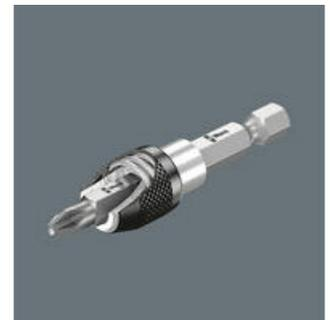
Wera Schnellwechselfutter stellen eine feste, wackelfreie Verbindung zwischen Halter und Bit her. Die Halter sind so konstruiert, dass beim Bitwechsel die äußere Hülse nach vorn geschoben wird und der Bit leicht eingesetzt und entnommen werden kann. In unmagnetischer Ausführung zur Verhinderung des ungewollten Anziehens von Metallspänen.
