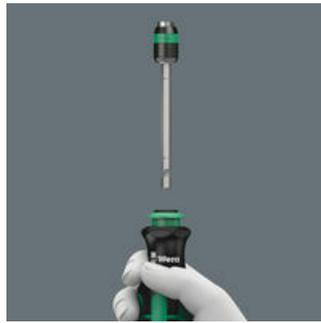
Durch erneutes, kräftigeres Betätigen der Hülse wird der Lösemechanismus durch ein deutlich hör- und fühlbares Überwinden des Arretierwiderstandes gelöst. Die Teleskopklinge kann entnommen und als Maschinenadapter eingesetzt, sowie in die Ausgangslage zurückgeführt werden.
