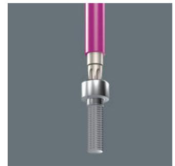
Die von Wera entwickelten TORX® HF Werkzeuge zeichnen sich durch eine geometrische Optimierung des ursprünglichen TORX® Profils aus. Durch die aus der Flächenpressung zwischen der Abtriebspitze und Schraubenprofil resultierende Klemmkraft werden TORX® Schrauben nach Spezifikation Acument Intellectual Properties sicher auf dem Werkzeug gehalten! Besonders hilfreich in schwer zugänglichen Arbeitsbereichen, wo man die zweite Hand nicht zum Festhalten der Schraube nutzen kann.
