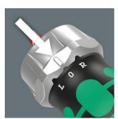
Die Ratschenmechanik feinverzahnt für einen geringen Rückholwinkel. Über den Umschaltring kann die Schraubrichtung rechts/fest/links vorgenommen werden. Die magnetische Bitaufnahme ist für 1/4"-Außensechskantantrieb nach DIN ISO 1173-C 6,3 und Wera Anschluss-Reihe 1 geeignet.
