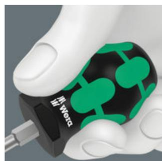
Der 2-komponentige Kraftform Griff ermöglicht hohe Kraftübertragung durch die abrutschfesten weicheren Griffbereiche und hohe Arbeitsgeschwindigkeit durch die harten Griffbereiche, die ein schnelles Umgreifen ermöglichen.
