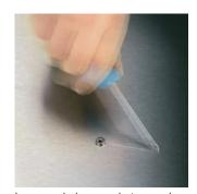
Immer wieder passiert es, dass man beim Verschrauben aus der Schraube rutscht. Manchmal dabei werden wertvolle Oberflächen beschädigt oder man verletzt sich sogar. Die Spitze von Wera Lasertip-Schraubendrehern wird mit Laserstrahlen mikroskopisch aufgeraut. fein Diese raue Oberfläche "beißt" sich förmlich im Schraubenkopf fest. Das unbeabsichtigte Herausrutschen kann damit vermieden werden.
