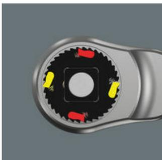
Durch die Doppelklingenkonstruktion wird aus 38 robusten Zähnen eine 76er Feinzahn-Teilung erreicht. Diese 76er Teilung führt zu einem sehr geringen Rückholwinkel von 4,7°.
