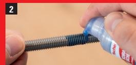
Mit SCHRAUBEN SICHERUNG beschichten.
